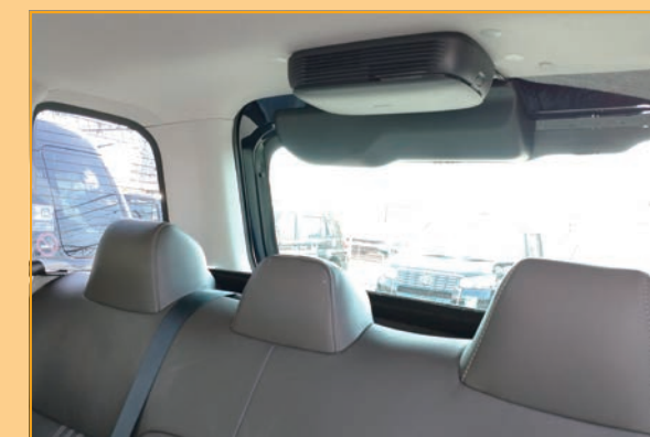
天井に設置された空気清浄機
